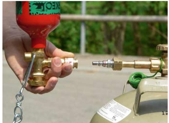
Propangas sicher und ohne Werkzeug umfüllen: mit der Schnellkupplung „Quicky“.
