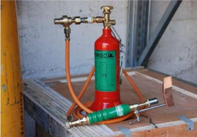
Zum einfachen Befüllen lässt sich der Brennerschlauch der Kleinflasche durch Abziehen lösen. In die Schnellkupplung ist auch eine Gas-Stopp-Funktion integriert.
