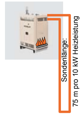
■ Bild 3: Reduzierung der Sondenlänge durch Absorptionstechnik. Bild: Isocal
